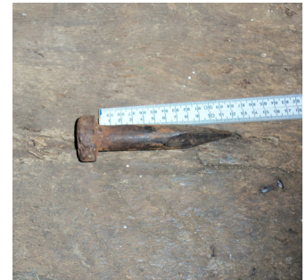
Spijkerbout, waar de springbeugel mee vast zit aan de penbalk
