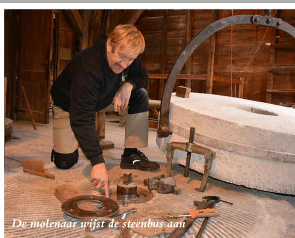
De loper in de steenkraan. De ligger met bolspil, de steenbus en de nodige gereedschappen
