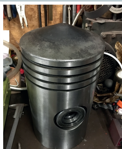
Losse zuiger en een gemonteerde inclusief drijfstaag. De zuiger beweegt heen en weer door de explosie in de verbrandingskamer en brengt middels een krukas het vlieg wiel (jachtwiel) in
