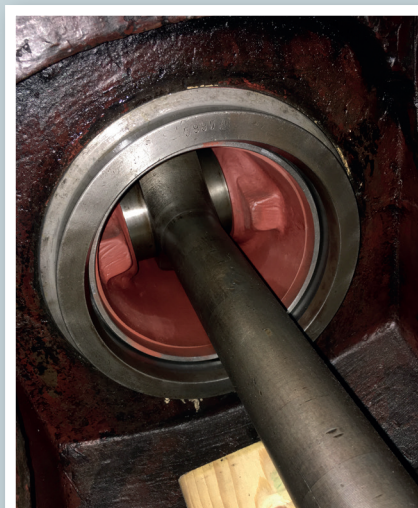
Losse zuiger en een gemonteerde inclusief drijfstaag. De zuiger beweegt heen en weer door de explosie in de verbrandingskamer en brengt middels een krukas het vlieg wiel (jachtwiel) in
